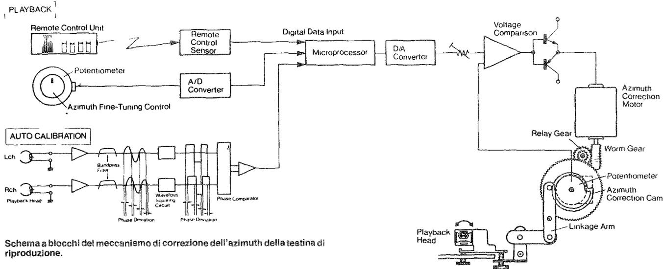
Schema a blocchi del meccanismo di correzione dell'azimuth della testina di riproduzione.
